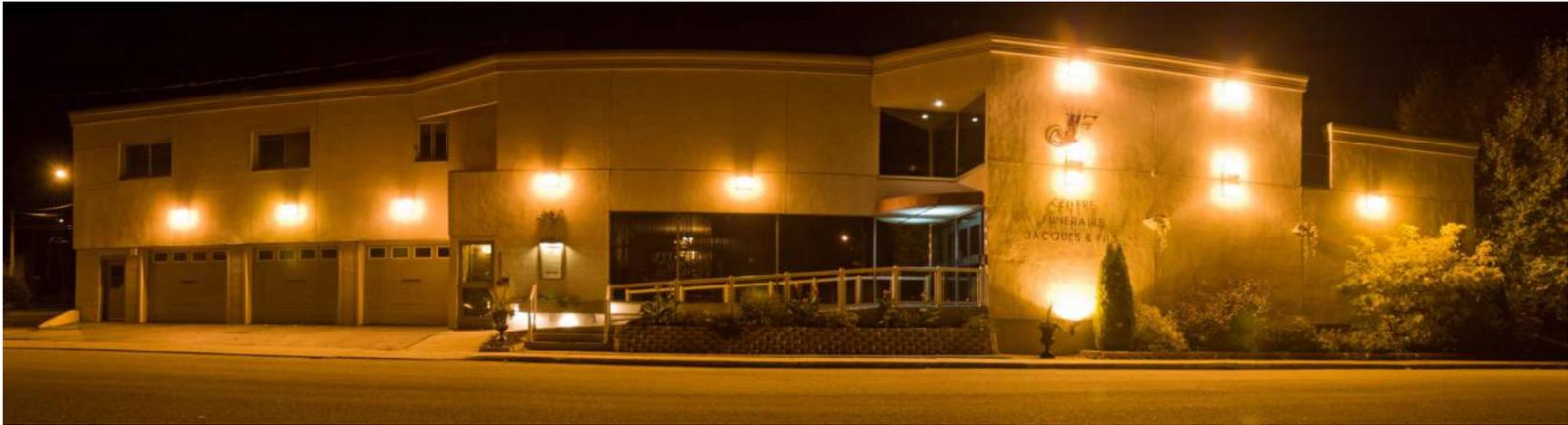
Suite au programme de conversion de luminaires mis sur pied par l'ASTROLab du Mont-Mégantic, ce même commerce n'utilise plus que 13 appareils munis d'ampoules de 70 W, réduisant ainsi sa puissance totale de 1340 watts.
