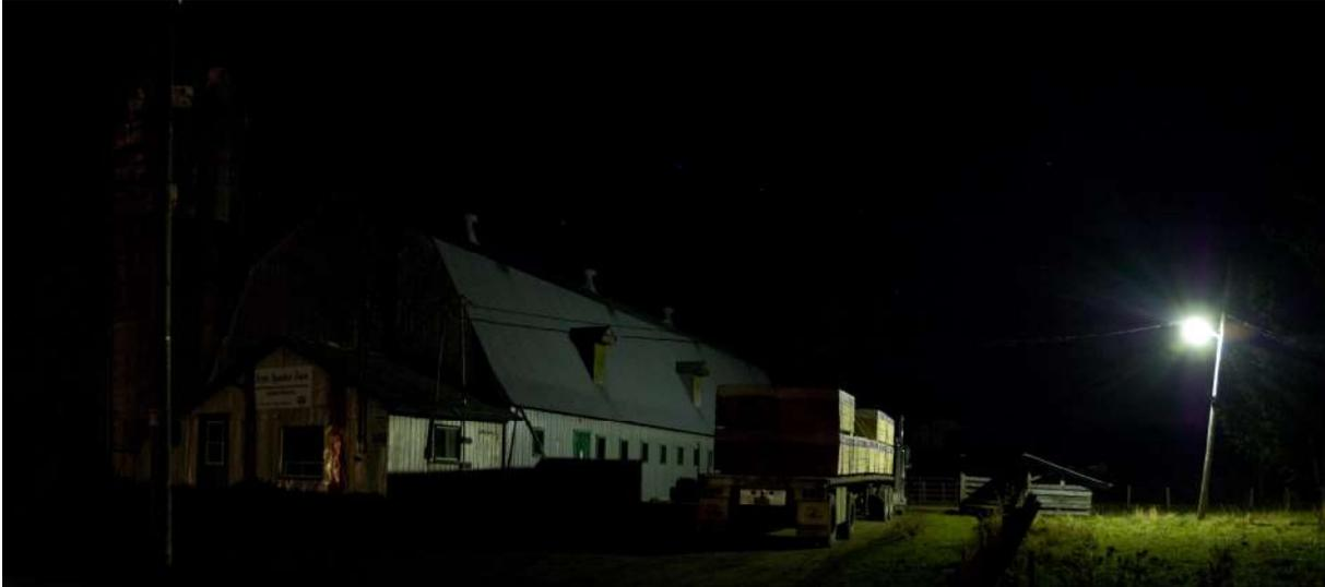
Le nouvel appareil muni d'une ampoule de 70 watts au sodium haute pression procure en éclairage bien suffisant pour cette aire de circulation. Malheureusement, cette photo après la conversion a été prise pendant l'hiver et la version « été » n'est pas encore disponible.
