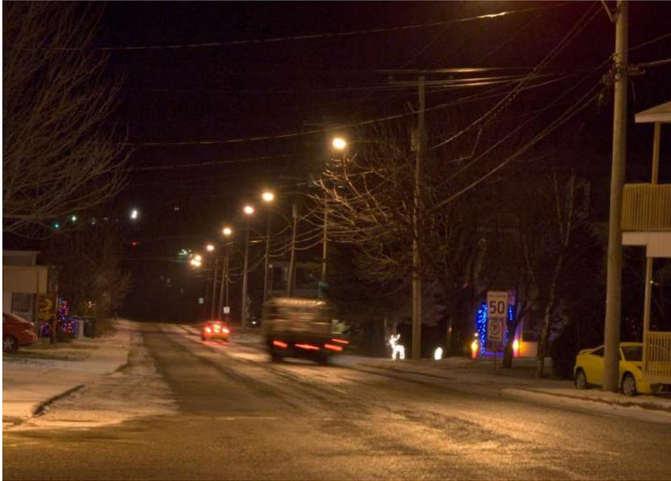
Grâce au programme de conversion, des luminaires de type Helios munis de lampes au sodium à haute pression de 70 W ont remplacé les anciens. Le contrôle optimal du flux lumineux a permis de faire en sorte que les luminaires n'éclairent ni le ciel, ni les façades des maisons avoisinantes. La rue est éclairée plus sobrement grâce à un éclairage au sol de 8 à 10 lux.
